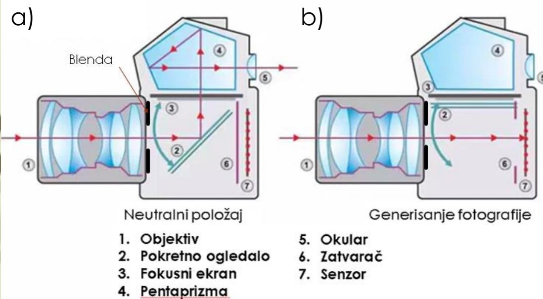
U zavisnosti od intenziteta i talasne dužine svetlosti, senzor generiše napon na svakom elementarnom delu „pikselu“ stvarajući digitalni zapis koji se reprezentuje kao digitalna fotografija.
